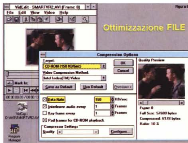
Figura 8 - Le performance che WinVideo e Smart Video Recorder hanno ottimizzato in base alle caratteristiche dell' MPC usato nella prova (un 386 a 40 MHz con 8 Mbyte di RAM e scheda grafica accelerata) ci portano infine ad individuare nella risoluzione 192x144 a 10 frame al secondo e con compressione a valore «quattro», i parametri per acquisire in maniera ottimale. Dal quadro di preview è possibile notare che le immagini, dal valore originale di 57Kbyte ad appena 6Kbyte, vengono conservate ad alti livelli di qualità.
