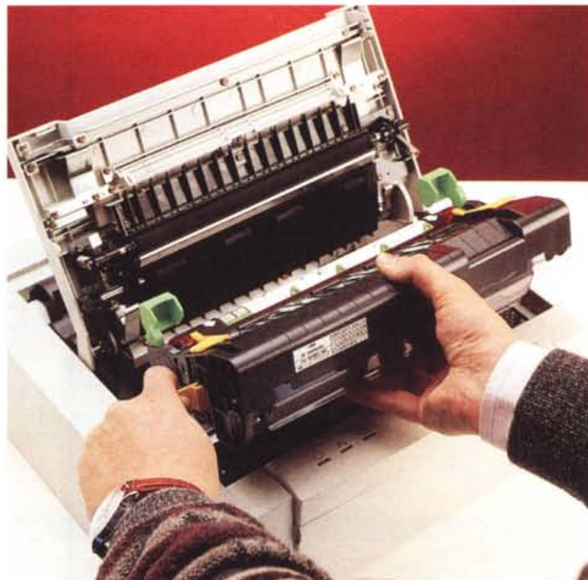
Ribaltando il vassoio di raccolta dei documenti si accede all'interno per il posizionamento della cartuccia toner.
