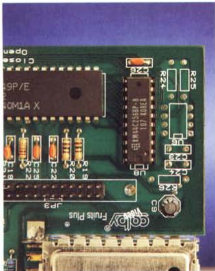
In questo chip da un megabit la scheda memorizza le pagine televideo ricevute.
