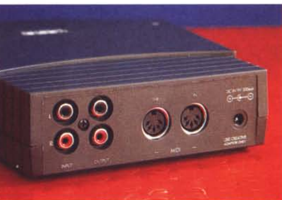
Midi Blaster è un modulo stand alone compatibile General MIDI. A corredo è fornito anche il sequencer a 256 tracce «Cakewalk Apprentice for Windows».
