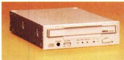
Il drive CD-R Yamaha CDR100 capace di scrivere e leggere fino a velocità quadra.
