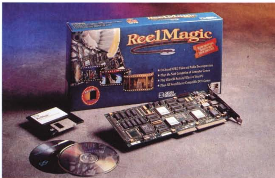
La scheda Reel Magic MPEG1 si installa nel PC in una comune slot a 16 bit.
