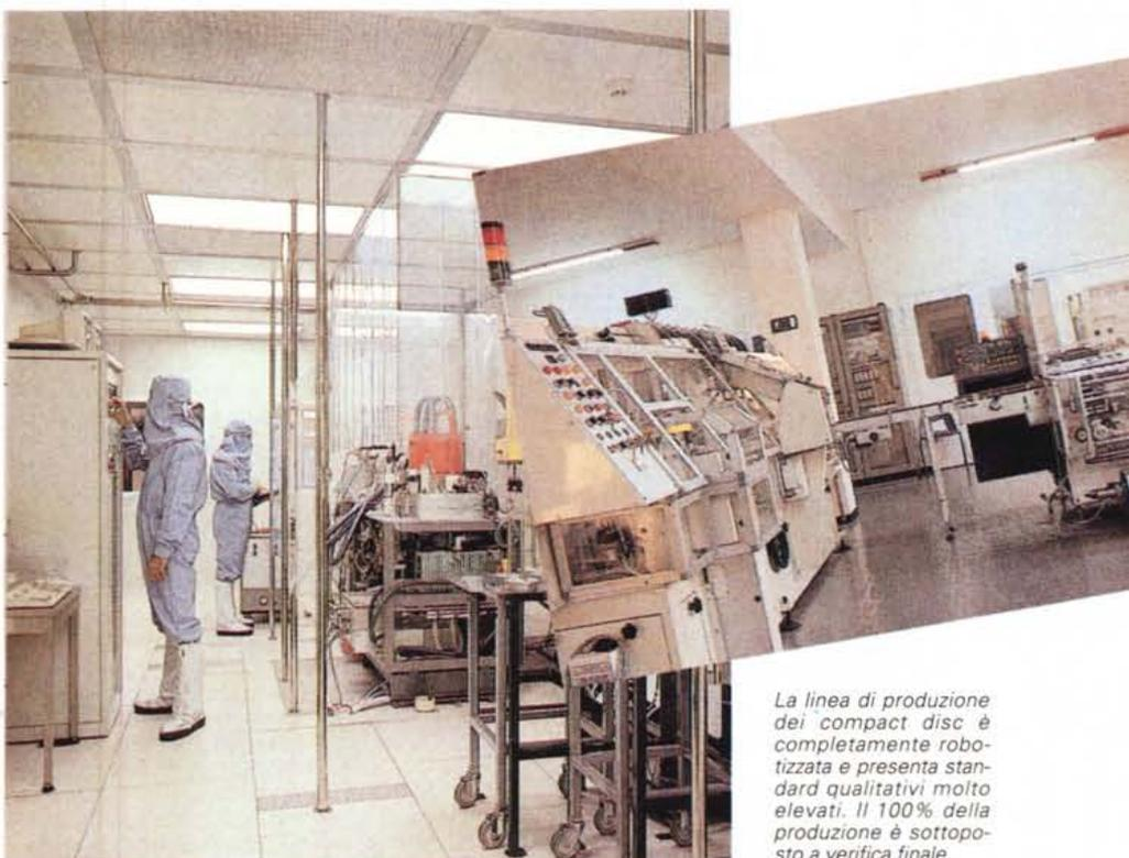
*La linea di produzione dei compact disc è completamente robotizzata e presenta standard qualitativi molto elevati. Il 100% della produzione è sottoposto a verifica finale.*
