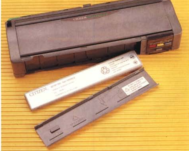
Il coperchio frontale nasconde l'accumulatore al Nichel Cadmio che garantisce un'autonomia prolungata rispetto alla precedente PN48.
