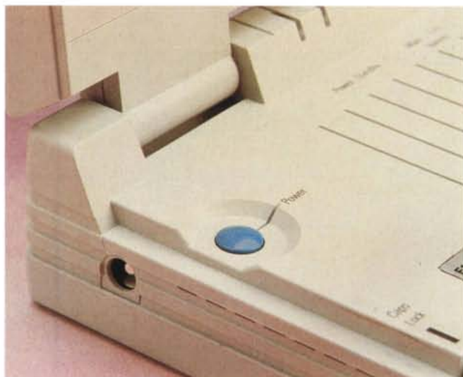
L'interruttore di alimentazione è, in verità, poco protetto.
