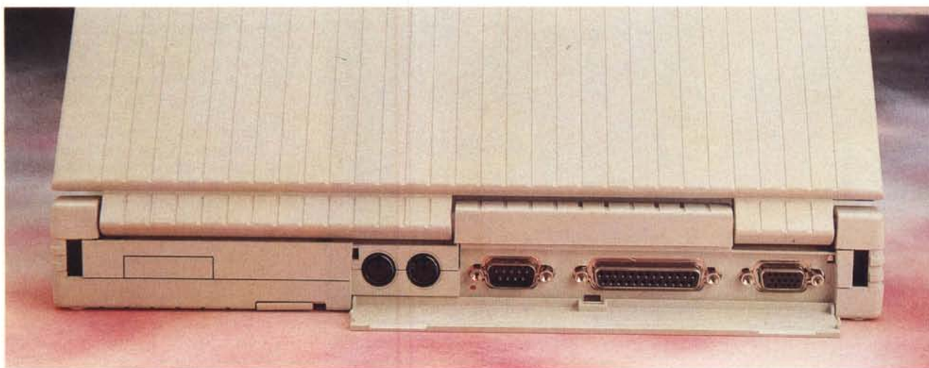
Sul retro le varie connessioni sono protette da uno sportellino in plastica.
