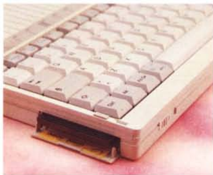
Sul lato sinistro troviamo l'alloggiamento PCMCIA.
