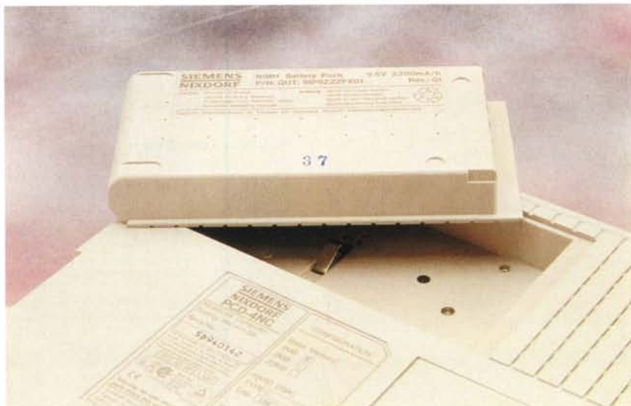
La batteria ricaricabile è accessibile dal fondo.
