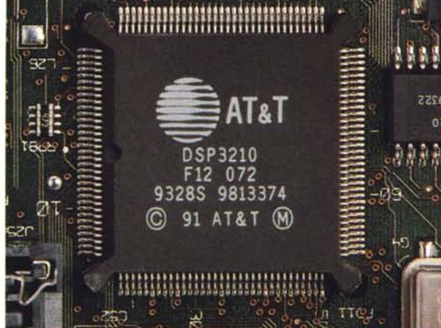
L'elettronica è assemblata su una scheda di piccole dimensioni. In alto, particolare del DSP AT&T 3210 a 55 MHz.
