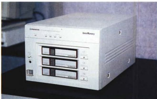
◀ Il nuovo Pioneer DRM-1804X non solo può contenere fino a diciotto CD-ROM, ma può trasferirne i dati ad una velocità di 614 KB al secondo.
