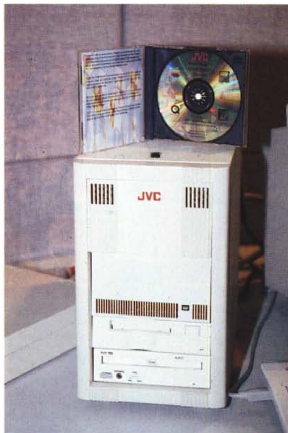
▶ La JVC ha realizzato il sistema Personal Rom-Maker per realizzare CD-ROM direttamente in un'unica unità con lettore, registratore, hard disk e tape backup.
