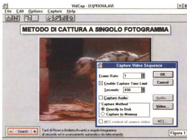
Capture Video Sequence. Il setting relativo al frame rate per l'acquisizione a «passo singolo»!
