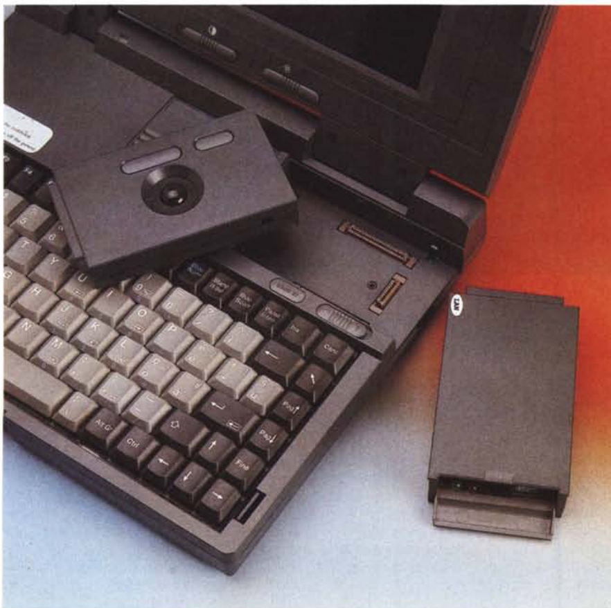
La caratteristica più originale del portatile Master è la possibilità di installare moduli d'espansione. Di serie è fornito il modulo trackball al posto del quale possiamo inserire un modem/fax, un adattatore LAN, una parte SCSI, un «drive» per schede PCMCIA o modulo multimediale con scheda audio e ingresso joystick.
