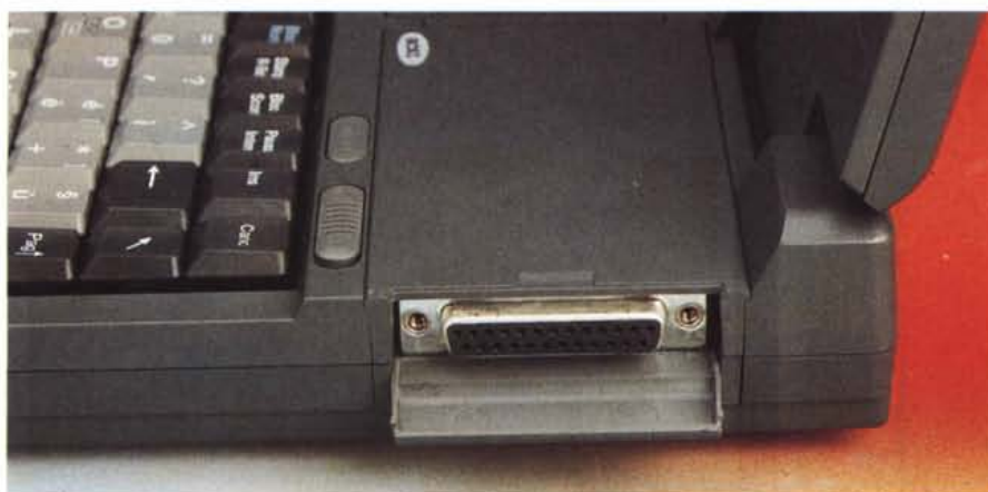
A seconda del tipo di modulo installato, troveremo connettori anche sul lato destro (nella foto l'adattatore SCSI).
