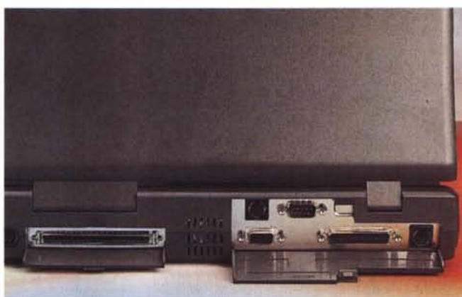
Sul retro le connessioni sono tutte protette da sportellini. È presente anche un connettore per box di espansione.
