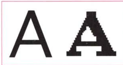
Figura f - Un font bitmapped (a destra) a confronto con uno TrueType.
