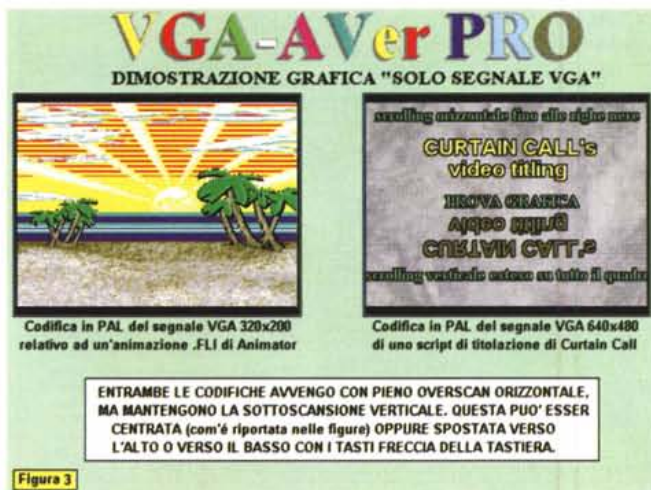
Figura 3 - VGA-Aver Pro: dimostrazione grafica solo segnale VGA. Quando si passa a videoregistrare sia un segnale 320x200 (Animator) che 640x480 (Curtain Call) entrambi vengono portati in overscan orizzontale con la limitazione di quello verticale. Se ne deduce che la VGA-Aver Pro opera lo stesso trattamento sia alle basse che alle alte risoluzioni.
