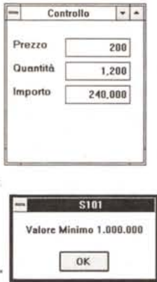
Figura 15 - Visual Basic 3.0. Qui vediamo come si possa addomesticare una Text.Box per gestire un'immissione numerica controllata. In caso di campi calcolati o di campi che debbano subire dei controlli risultano molto utili alcuni... eventi. Il GotFocus, quando il cursore «entra» nella Text.Box e quindi occorre attribuirgli il valore iniziale, e se del caso, selezionarlo, il LostFocus, quando si «esce» e si possono eseguire le istruzioni di controllo. L'istruzione T2.SetFocus, riporta il cursore nella TextBox T2.
