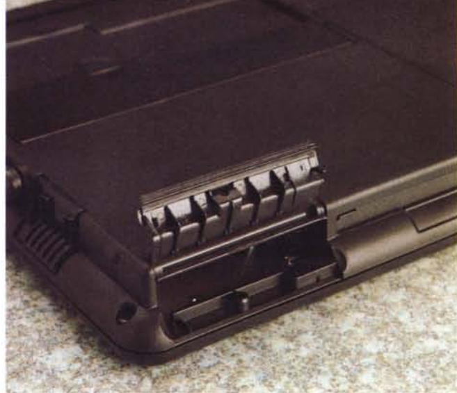
È presente anche un alloggiamento per due schede PCMCIA.
