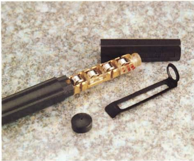
All'interno della penna attiva troviamo ben quattro pile a "bottono"
