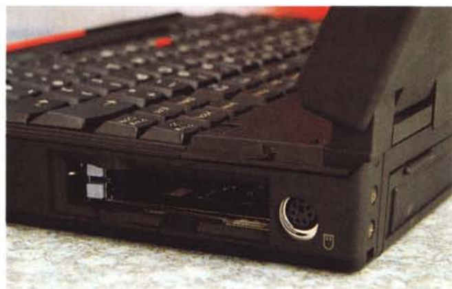
La meccanica per floppy disk si affaccia sul lato frontale. A destra è presente la presa per il mouse e l'alloggiamento per schede PCMCIA.
