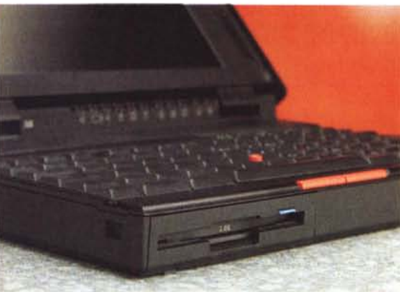
La meccanica per floppy disk si affaccia sul lato frontale. A destra è presente la presa per il mouse e l'alloggiamento per schede PCMCIA.
