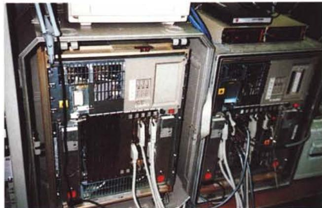
*A sinistra, la sala macchine della base. Qui sopra, un dettaglio sui due Micro-VAX «antartizzati», ossia modificati per resistere alle condizioni antartiche.*
