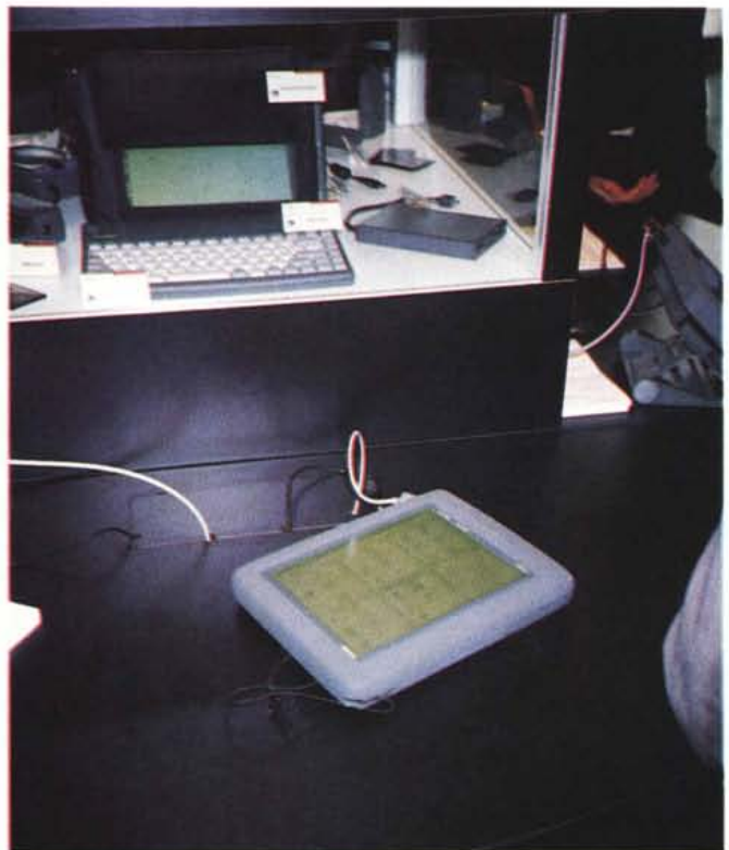
Toshiba Dynapad T100X: basato su Microsoft Windows per Pen Computing e su una penna «attiva» il Toshiba Dynapad ha tutte le carte in regola per far parte della famiglia dei Pen Based Computer. Processore Am386SXLV a 25 MHz, memoria da 4 a 20 megabyte, hard disk da 40 o 80 megabyte, slot PCMCIA, schermo VGA a 16 livelli di grigio, tastiera opzionale, batterie ricaricabili per 2 ore e mezza di autonomia sono le sue caratteristiche principali.
