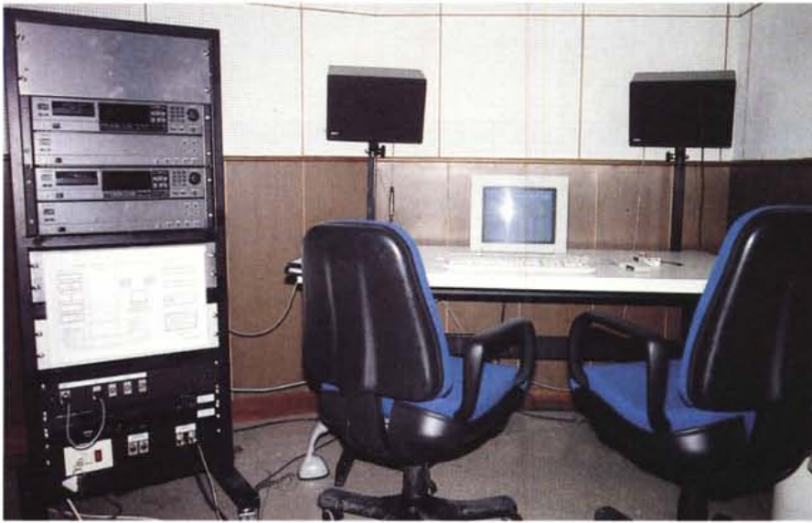
Figura 9 - L'ambiente di lavoro, nel Centro di Produzione della Radio Vaticana, dove è sistemato il Sonic System; a sinistra il rack delle macchine accessorie, DAT e convertitori A/D D/A.
