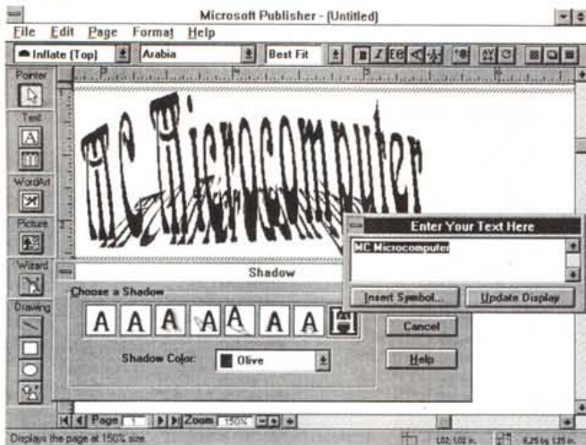
Figura 14 - Windows Funzioni di Servizio - OLE 2.0 finalmente. Tra gli aspetti tecnicamente più evoluti ed interessanti di Windows vanno citati quelli legati al trasferimento di dati tra due applicativi. Il Client, il destinatario, e il Server, il mittente. La tecnologia relativa si è enormemente sviluppata. Si è passati dal vecchio e rudimentale ClipBoard al DDE e ora al sofisticatissimo OLE 2.0, evoluzione del vecchio 1.0. Le prossime release dei vari applicativi dovranno essere OLE 2.0 compatibili. I primi due prodotti sono Microsoft Visual Basic 3.0, provato in questo numero della rivista e Microsoft Publisher 2.0, dal quale abbiamo preso questa videata. La Toolbar che appare nell'ambiente Publisher non è sua ma è del prodotto Server. L'integrazione è totale al punto che l'utente può ignorare il fatto che sta sfruttando addirittura un Server.
