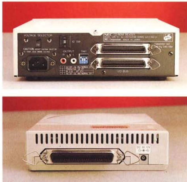
Il kit di interfaccia CD-XT003 si compone essenzialmente di una scheda di interfaccia half-size e dei driver software di gestione. Il retro delle due unità mostra i connettori di interfaccia e di alimentazione.
