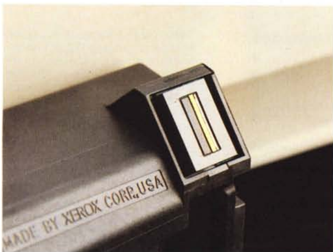
Particolare della testina di stampa con i suoi 128 ugelli.
