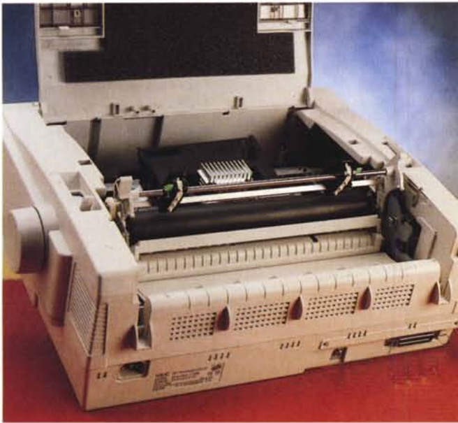
Da notare le due possibilità di montaggio del trattore (di spinta o a tirare).
