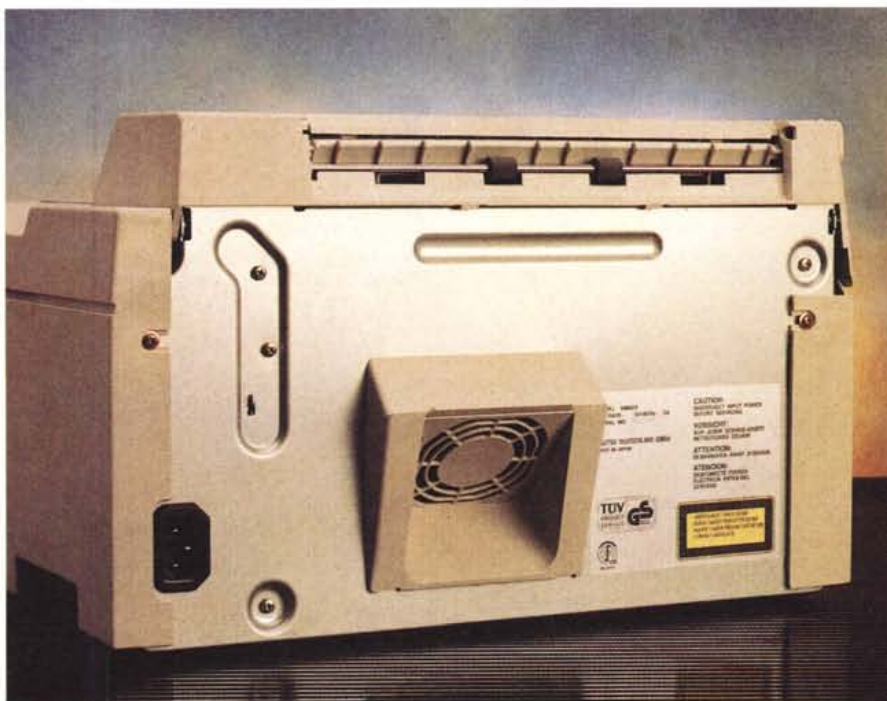
► La parte posteriore con la grossa ventola di raffreddamento.
