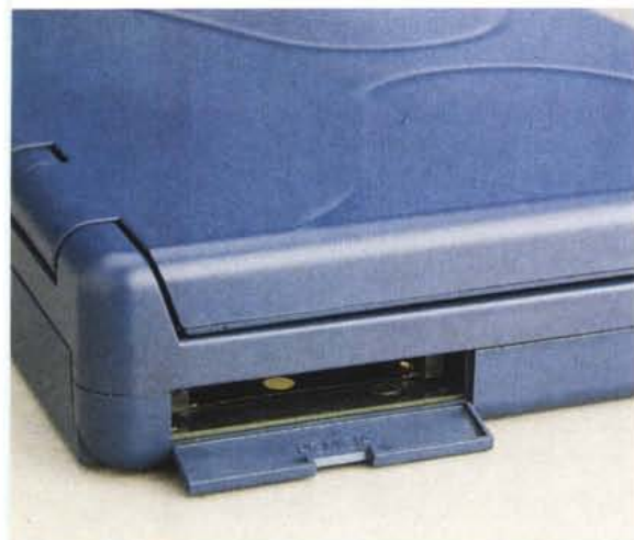
Sul lato sinistro l'alloggiamento per schede PCMCIA.
