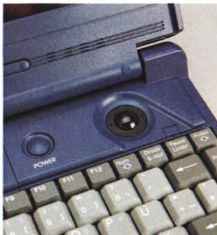
La trackball integrata posizionata sopra la tastiera.
