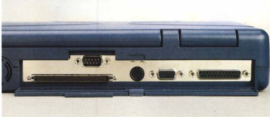
Sul retro della macchina porta seriale, parallela, tastiera esterna e connettore per Docking Station.
