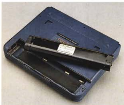
La batteria ricaricabile è accessibile dal fondo.
