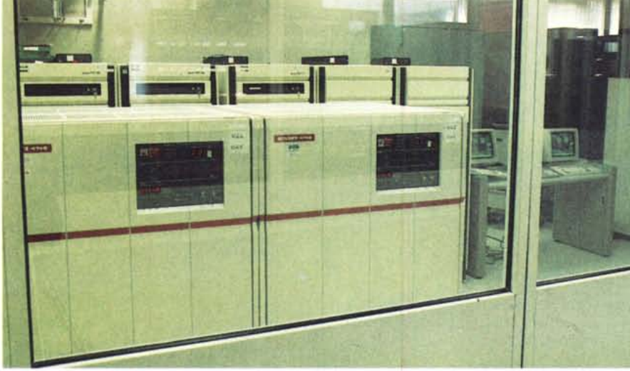
Le due unità di controllo linee Amdahl 4745; sullo sfondo gli Olivetti PSP 300 e PSP 3 (questi ultimi relativi al sistema locale).
