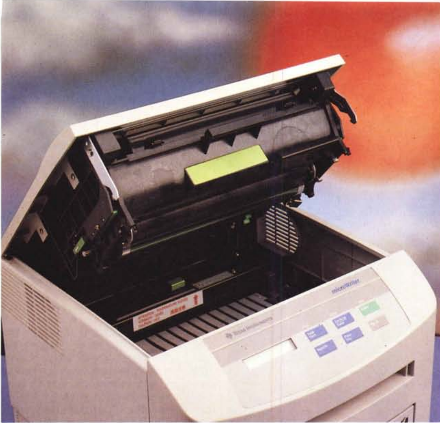
Il vano cartuccia/toner e la meccanica interna.
