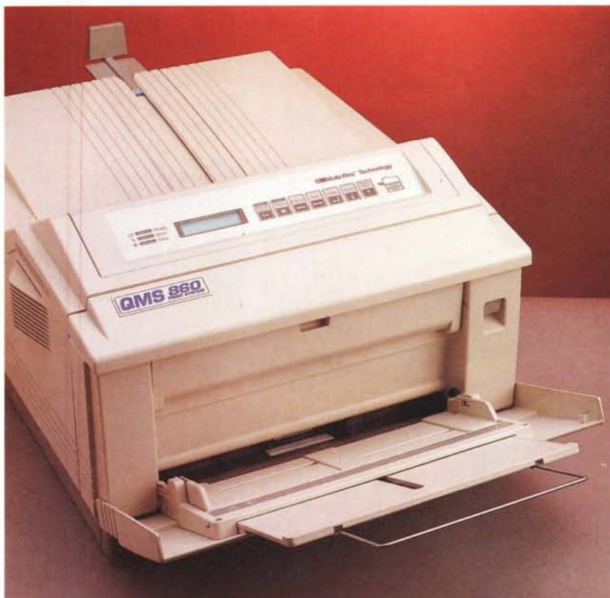
Il pannello anteriore cela un vassoio di alimentazione, regolabile nel formato, capace di accettare fino a 100 fogli in aggiunta ai 250 disponibili nel cassetto inferiore.
