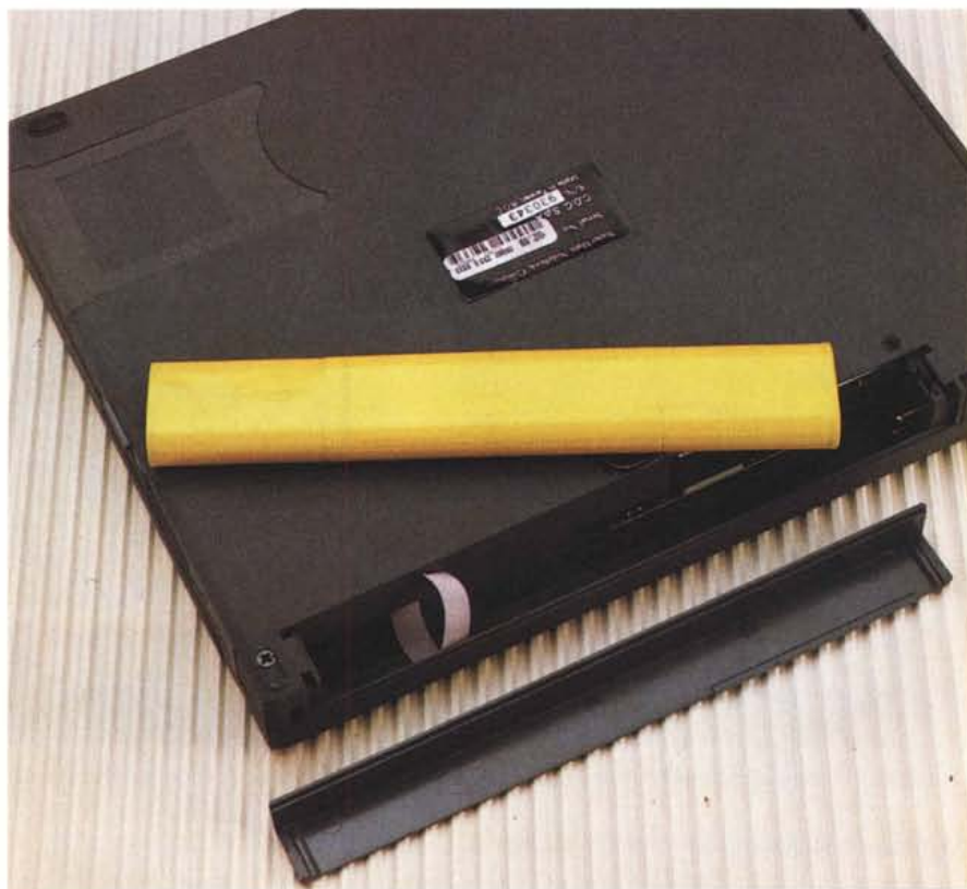
La batteria ricaricabile assicura circa un'ora di funzionamento autonomo.
