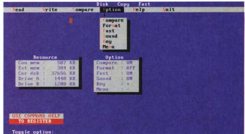
memoria estesa per velocizzare le operazioni e per evitare l'uso del disco rigido. Le operazioni sono anche velocizzate attraverso la copiatura e scrittura delle sole porzioni di dischetto che contengono dati, ignorando le altre.
