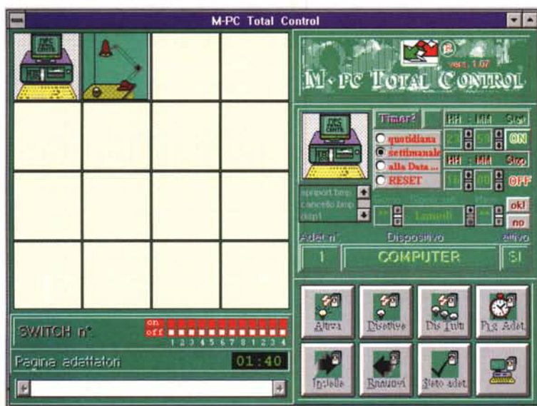
La sezione di programmazione del timer attiva; in basso a sinistra l'indicazione relativa ai dip switch del ricevitore corrispondente al dispositivo controllato.
