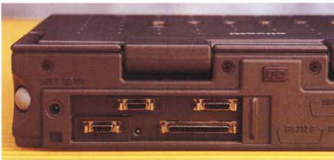
◀ Sul retro le connessioni sono disponibili attraverso connettori non standard.
