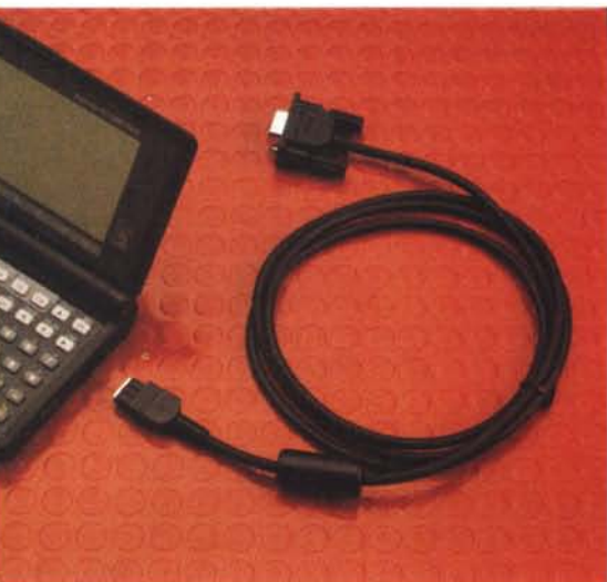
La comunicazione per lo scambio dei file può avvenire attraverso il ricetrasmittitore a raggi infrarossi incorporato (per interfacciarsi ad un altro HP) oppure tramite un cavetto ed un apposito software (per il collegamento ad un PC).
