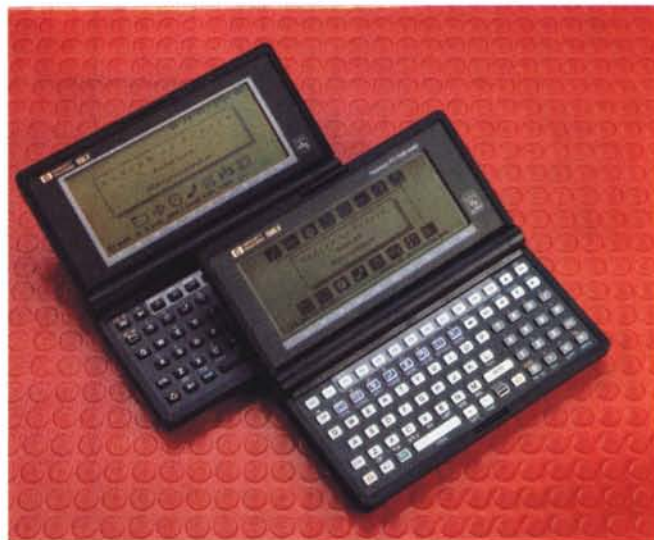
▶ A confronto con il precedente modello: notare il display a 80 colonne contro le 40 dell'HP 95.
