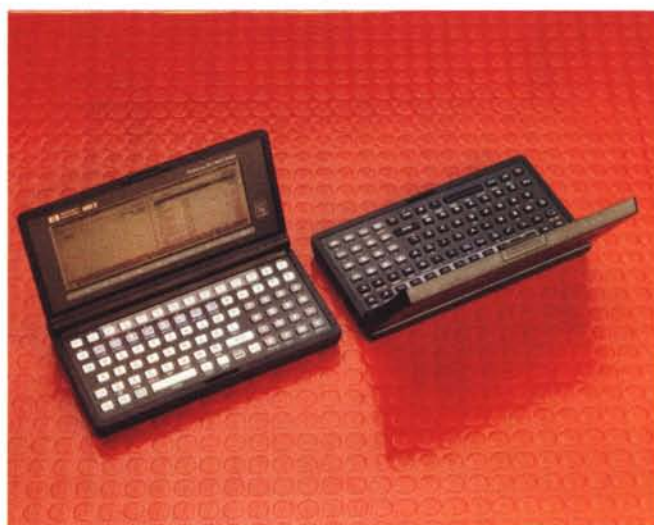
La comunicazione per lo scambio dei file può avvenire attraverso il ricetrasmittitore a raggi infrarossi incorporato (per interfacciarsi ad un altro HP) oppure tramite un cavetto ed un apposito software (per il collegamento ad un PC).
