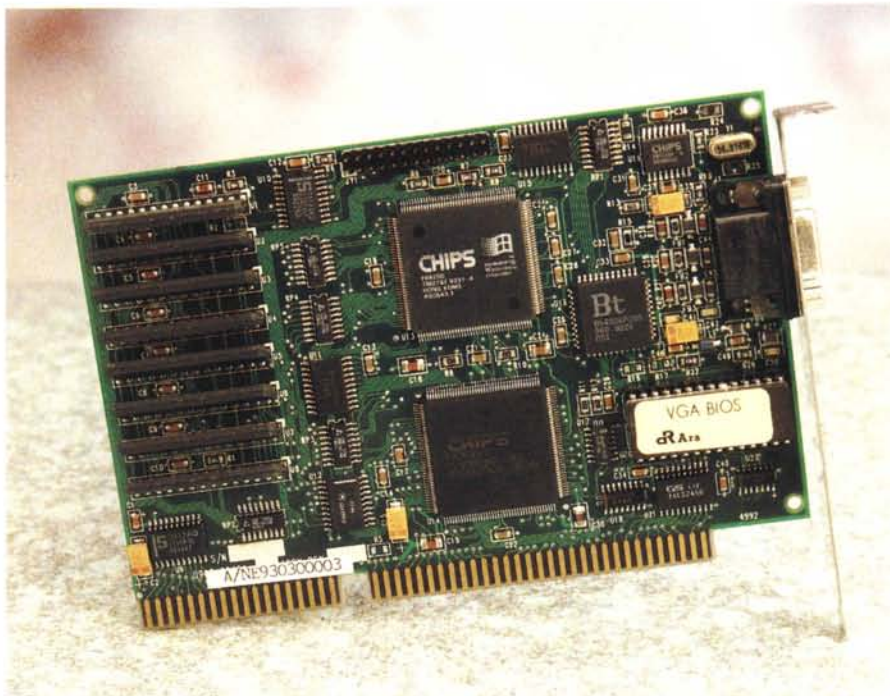
Figura 8 - Primo piano sulla Wingine, una scheda S-VGA espressamente realizzata per l'accelerazione grafica dell'ambiente di Windows. L'introduzione del Video Digitale obbliga all'acquisto di un «Windows accelerator». La Wingine di Chips & Technologies è fra le soluzioni migliori in assoluto.
