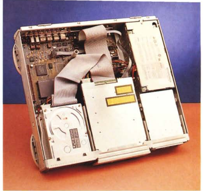
A sinistra in alto possiamo vedere la predisposizione per la porta Ethernet disponibile su alcune versioni di Centris 610. In alto la macchina appena aperta. A sinistra la piastra madre: si notano le sedi per alcuni chip mancanti (l'elettronica per Ethernet), il connettore PDS accanto al microprocessore e gli slot SIMM per espandere la memoria di sistema e la memoria video.
