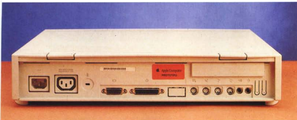
Sul retro della macchina troviamo tutte le connessioni per il mondo esterno: da notare la sede per una scheda interna NuBus. A destra vi sono i due pulsantini per il reset e per provocare un interrupt (utile ai programmatori).
