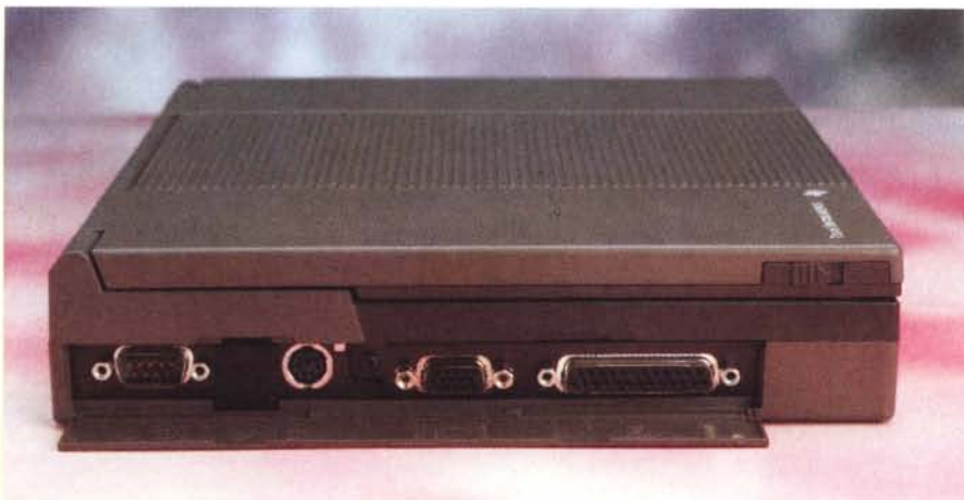
Le connessioni per l'esterno sono disponibili sul lato sinistro e sul retro.
