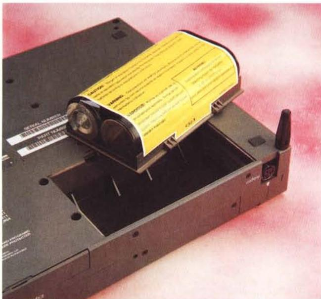
La batteria ricaricabile è situata sul fondo della macchina.
