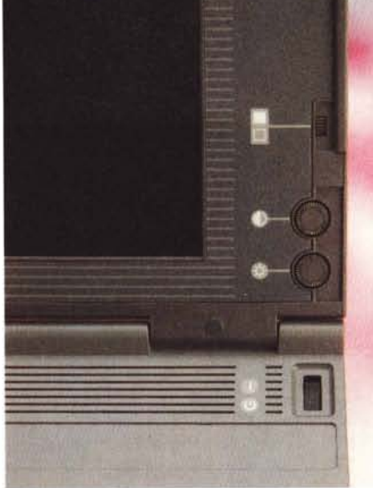
Accanto al display i controlli di luminosità e contrasto.
