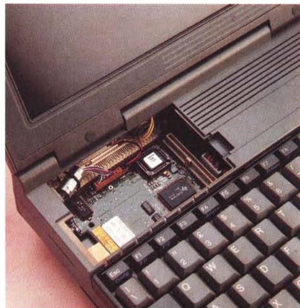
Tra tastiera e display troviamo l'alloggiamento per il modem interno opzionale.
