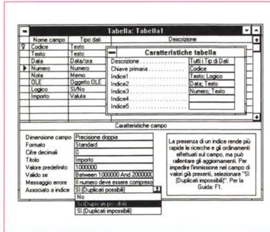
Figure 5, 6 - MS Access - Una Validazione con la clausola Between. L'importo deve essere compreso tra 1.000.000 e 2.000.000. In caso di errore deve apparire il messaggio che vedete nella figura dopo. Cogliam l'occasione per dire che, con Access, non è possibile definire a livello di struttura Campi Calcolati. Si potranno definire successivamente in sede di Query (che vediamo in questo stesso articolo) e in sede di Scheda (che vedremo in seguito). Nella prima figura vediamo anche la Finestra di Dialogo da usare per la creazione di indici composti.
