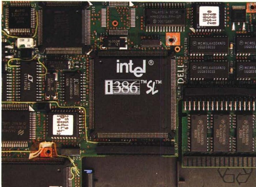
byte. Il livello costruttivo generale è molto buono anche se si notano diversi rattoppi sia elettrici che elettronici (alcuni componenti sono stati aggiunti incollandoli sopra ad altri chip e provvedendo poi con dei collegamenti elettrici volanti la comunicazione con le sedi opportune). L'esemplare in nostro possesso è però una macchina di preserie e probabilmente i notebook venduti al pubblico avranno già una nuova release della scheda elettronica.
