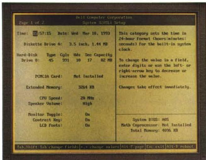
Con la combinazione di tasti Fn+F1 accendiamo al programma di Setup col quale possiamo effettuare alcune scelte o controllare lo stato di carica delle batterie.
