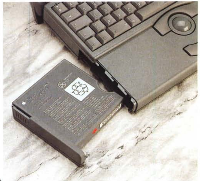
La batteria ricaricabile è facilmente accessibile lateralmente. ►
