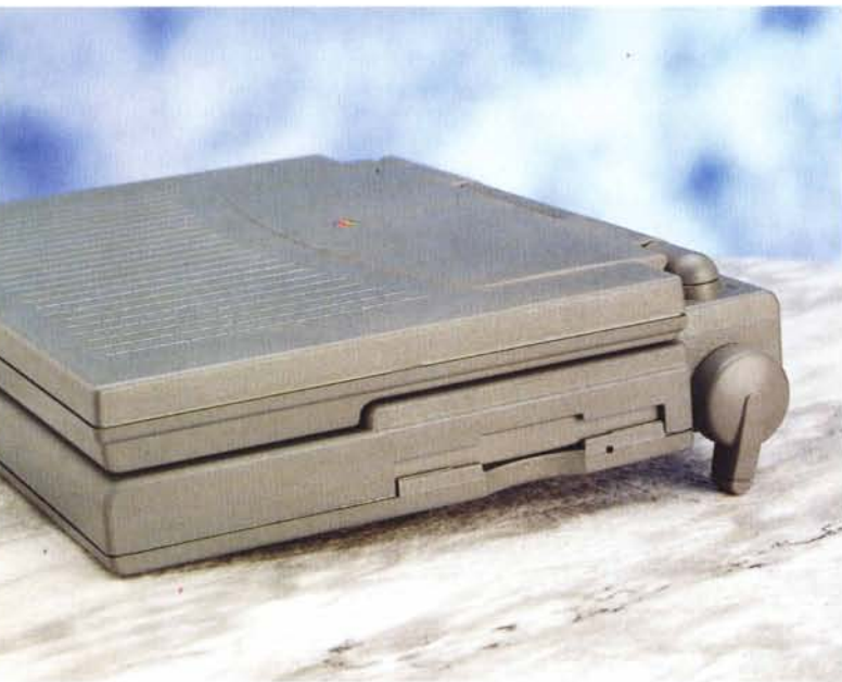
Il superdrive è accessibile dal lato destro della macchina. Legge sia i dischi Mac che MS-DOS.
