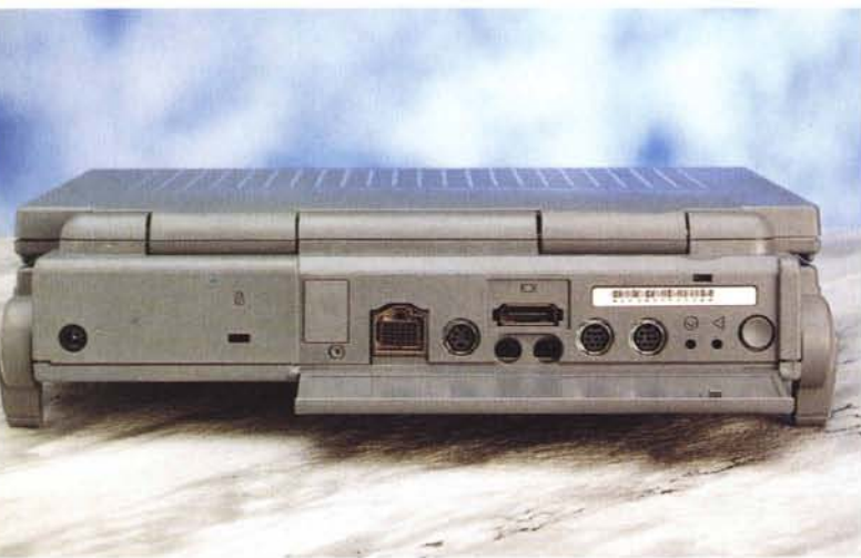
Sul retro della macchina tutte le connessioni sono protette da uno sportellino di plastica.
