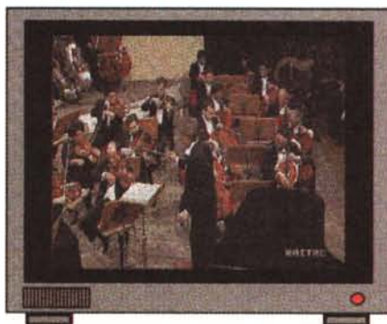
Figura 3b Risoluzione 640 x 512 PAL a sottoscansione. Lo stesso segnale, trattato sempre senza overscan, ma con scansione PAL presenta la cornice nera leggermente meno spessa.
