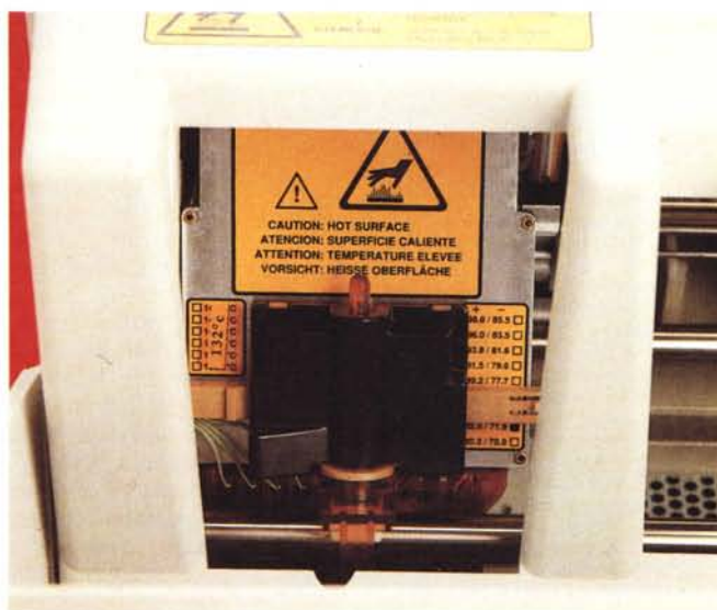
Aperto il pannello sul retro della Phaser IIIIXPI si può accedere al gruppo termico che provvede alla fusione degli stick di colore precedentemente al loro trasferimento sul supporto di stampa.
