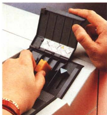
Ecco come si introducono gli stick cerosi all'interno della Phaser IIIPIXi.
