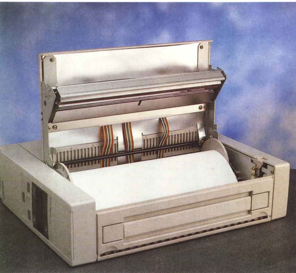
Una veduta generale del dispositivo con il coperchio, azionabile solo in posizione orizzontale, aperto per la sostituzione del rotolo di carta termica.
