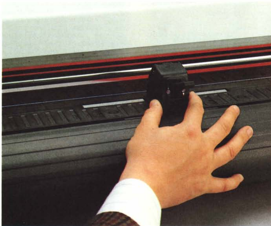
Uno dei meccanismi di guida carta, dotati ognuno di una leva di blocco, e la torretta porta-penne.
