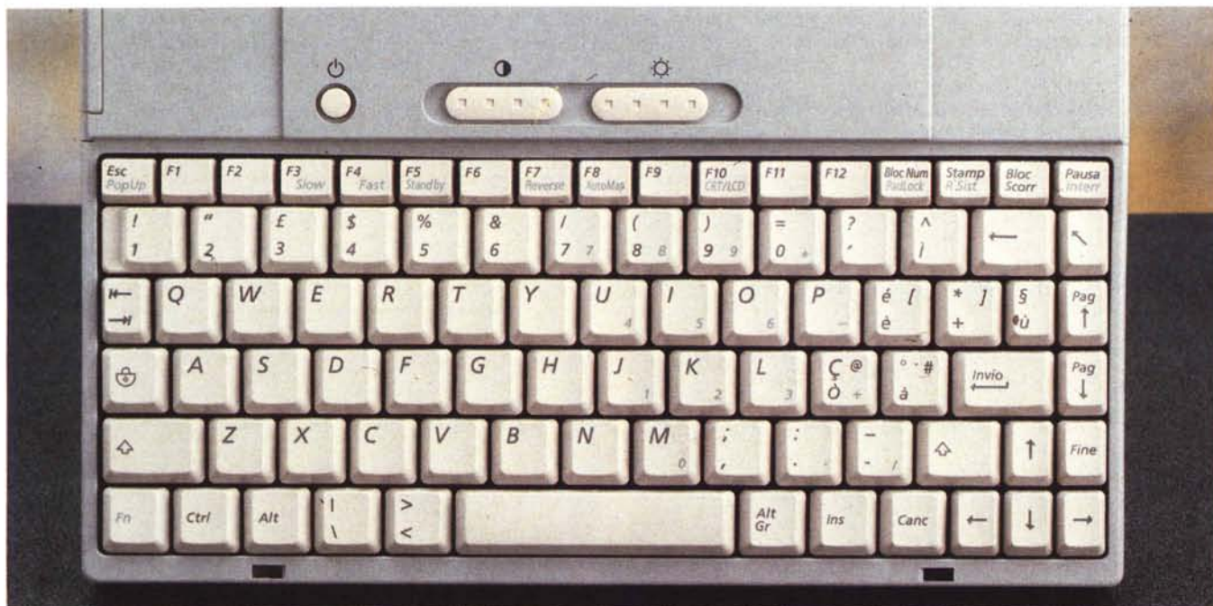
La tastiera è di ottima qualità, con i tasti tutti disposti correttamente ad eccezione del solo tasto backspace troppo vicino al tasto home.
