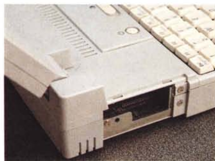
Sul lato sinistro troviamo l'alloggiamento per la scheda fax/modem.
