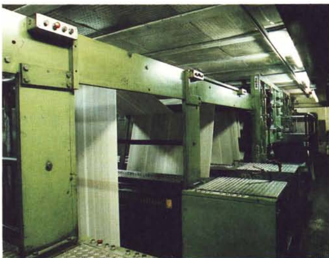
◀ Una rotativa del Messaggero: 60.000 copie l'ora per 48 pagine, quasi cinquantamila pagine al minuto! Il computer controlla molti passaggi, ma la tecnologia di stampa è ancora tradizionale.
