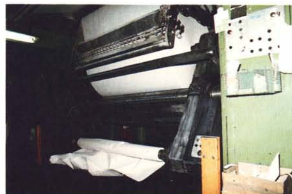
Una bobina di carta sta per finire, la seconda parte e accelera. Quando i sensori avvertono che i due fogli hanno la stessa velocità, il computer comanda il taglio e l'incollatura della carta.
