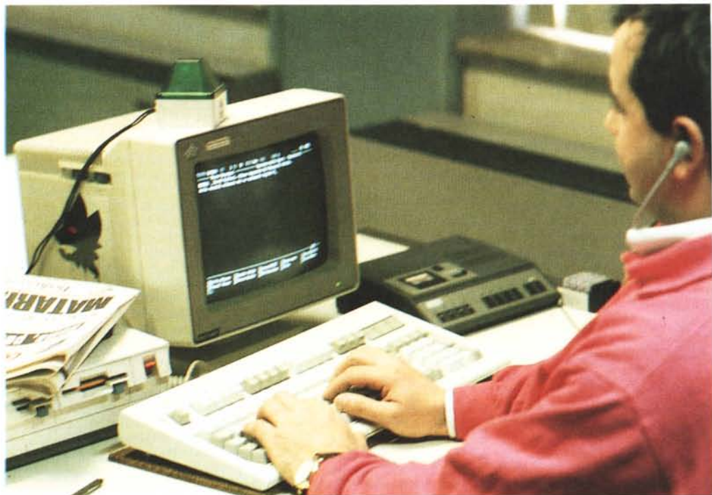
Un tempo gli inviati dettavano agli stenografi. Oggi c'è un registratore (dimafono). Il dimafonista trascrive la registrazione su un terminale del sistema editoriale.
