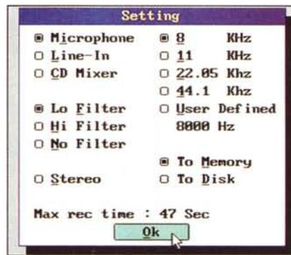
Voice Editor II. Il settaggio della fonte, la frequenza di campionamento e il tipo di filtraggio.
