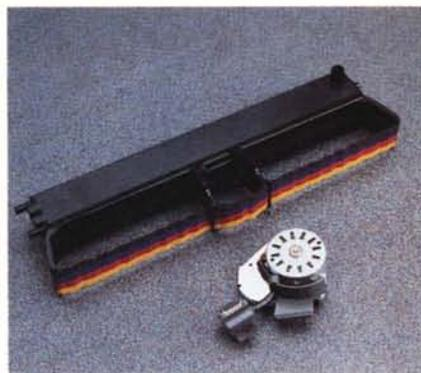
Close-up sulla testa di stampa ed, a destra, il kit colore comprendente anche il supporto motorizzato per la cartuccia di nastro.
