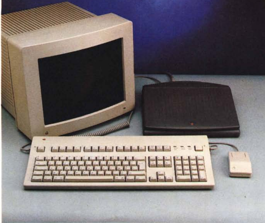
Panoramica di un tipico sistema PowerBook Duo più MiniDock più monitor, tastiera e mouse esterno.
