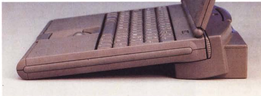
Con la MiniDock installata l'assetto di «guida» è lo stesso della macchina nuda con i piedini estratti.
