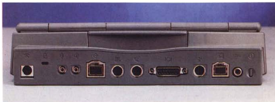
La MiniDock mette a disposizione tutte le porte standard dei Mac, compresa la porta video.
