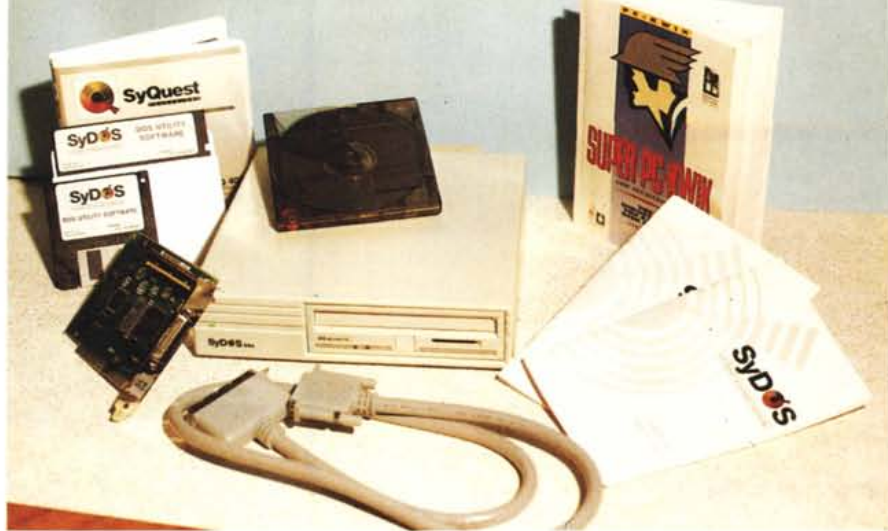
SyDOS 44e. Il frontale dell'elegante unità esterna con in evidenza la cartuccia da 44 Mbyte e la scheda SCSI d'interfacciamento.
